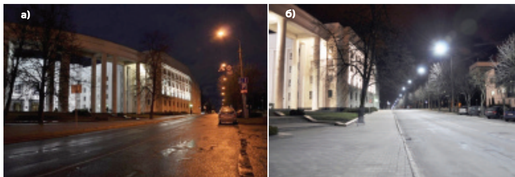
Рис. 2. Проекты, реализованные ГП «ЦСОР НАН Беларуси» в 2012–2013 гг.: освещение ул. Академическая (а) до и (б) после установки светодиодных светильников
