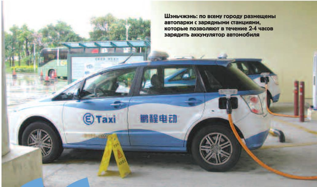
Шэньчжэнь: по всему городу размещены автопарки с зарядными станциями, которые позволяют в течение 2-4 часов зарядить аккумулятор автомобиля
