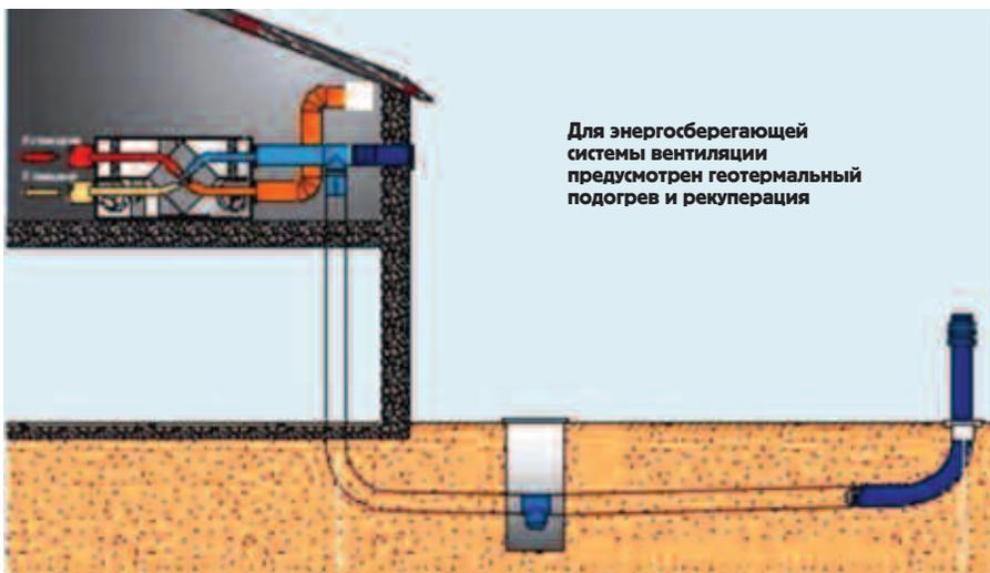
Для энергосберегающей системы вентиляции предусмотрен геотермальный подогрев и рекуперация
