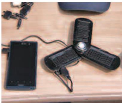
Зарядное устройство для мобильного телефона на базе солнечных батарей
