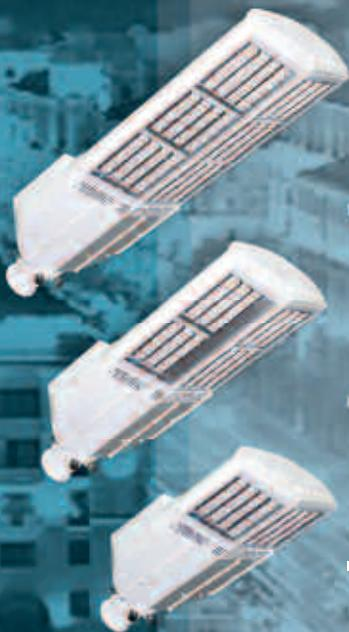
■ **КОРПУСНЫЕ ДЕТАЛИ** светильника изготовлены на основе экструзионных и литых под давлением деталей из алюминия с содержанием основного вещества в количестве 99,95%, что гарантирует наличие на поверхности корпусных деталей плотного защитного оксидного слоя перед его анодированием и покраской. Корпус светильника устойчив к коррозии в соответствии с 4.18.3 СТБ IEC60598-1. Корпус окрашен порошковой краской.
