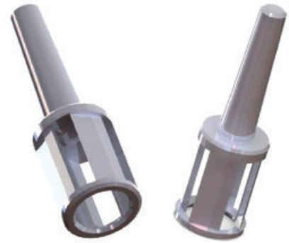
Рис. 5. Хвостовая фреза, обеспечивающая отвод стружки сквозь межзубую впадину
