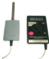
Термометр для измерения температуры и влажности окружающего воздуха
