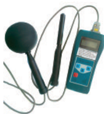
Прибор для измерения скорости движения воздуха и радиационной температуры
