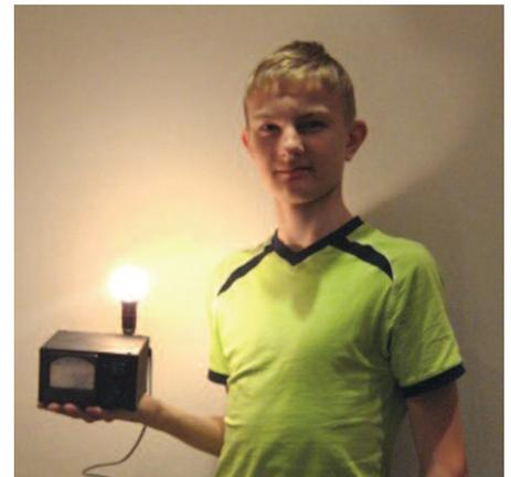
Раньше в подобных регуляторах применялся понижающий трансформатор, что доводило вес устройства до 5 килограммов. При создании этой схемы Андрей обошелся без понижающего трансформатора, что значительно уменьшило массу устройства. По словам Андрея, все необходимые для создания прибора радиодетали можно без труда и весьма недорого найти на радиорынке.
